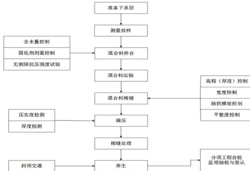
图1 固化粉煤灰基层（底基层）施工工艺图
