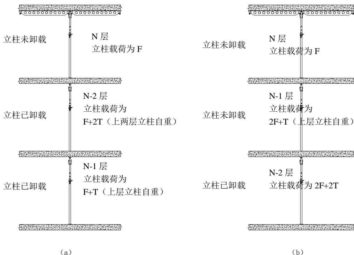
图 12 立柱荷载图
